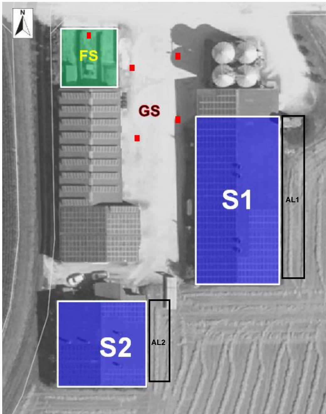
Abb. 5-3: Übersicht (Bauwerke und Emissionsquellen) der Hofstelle der Tierhaltung B3 auf Flurstück Nr. 563 mit Schweinehaltung. Die farbigen Markierungen bezeichnen die einzelnen Emissionsquellen, die Abkürzungen entsprechen den im Text verwendeten Bezeichnungen für die einzelnen Quellen bzw. Quell-Bereiche.
