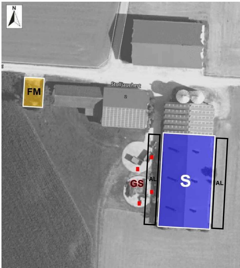
Abb. 5-1: Übersicht (Bauwerke und Emissionsquellen) der Hofstelle der Tierhaltung B1 mit Schweinehaltung auf Flurstück Nr. 652. Die farbigen Markierungen bezeichnen die einzelnen Emissionsquellen, die Abkürzungen entsprechen den im Text verwendeten Bezeichnungen für die einzelnen Quellen bzw. Quell-Bereiche.
